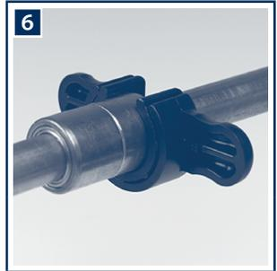
**Achtung:** Gewindeverbindungen sind vor dem Einstecken des cuprofit Fittings herzustellen, damit die Steckverbindung nicht mit Zugspannung vorbelastet wird. Nur blanke Kupferrohren (ohne Nickel bzw. Chromschicht etc.) in den cuprofit-Fitting einstecken! Steckverbindungen nur im drucklosen Zustand drehbar, um mögliche Beschädigungen des Kupferrohres zu vermeiden.
