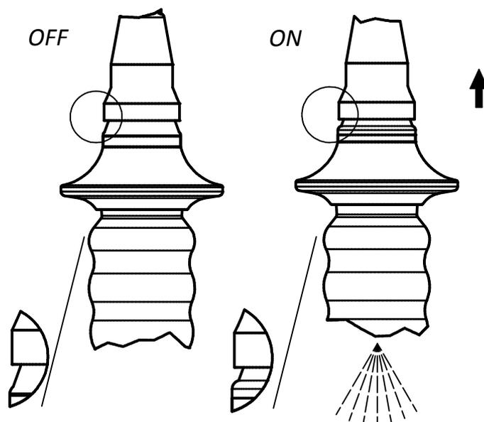
Zum Auslösen der Armatur wird der schwarze Ring mit der Hand ca. 1 mm nach oben gedrückt. Zum Schließen den Andruck lösen.
