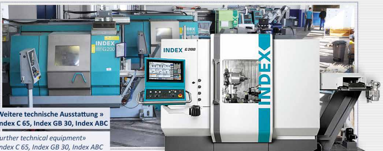
INDEX 5-Achs Dreh-Fräszentrum » G200 - Max. Durchlass ø65 mm - Stange, (oder) max. ø200 mm bei Einlegeteilen
