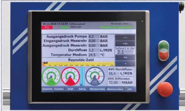
Messung Strömungswiderstand nach DIN EN 1267 flow resistance measurement, according DIN EN 1267
