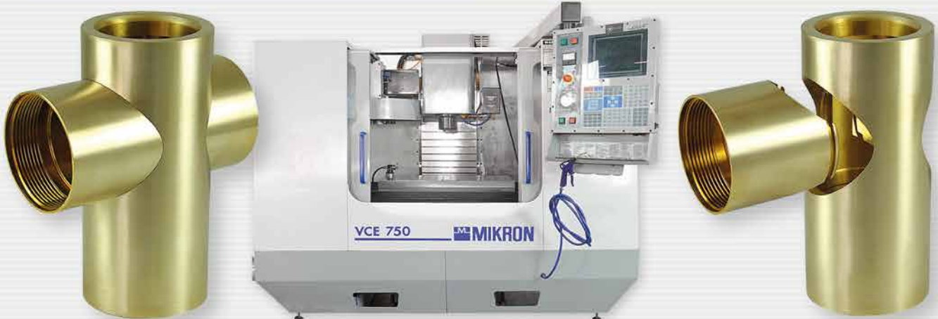
Fräsen / Bohren » Mikron CNC-Universalfräsmaschinen Verfahrwege » X 1000 / Y 500 / Z 600 (mm)
